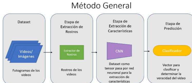
Fig. 1. Etapas del modelo general para detección de DeepFake. Creación propia.
